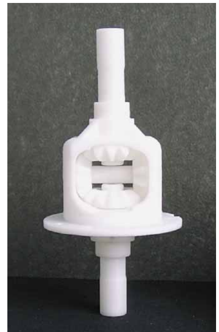
Abb. 3: Funktionsprototyp eines PKW-Hinterachsdifferenzials aus ABS
